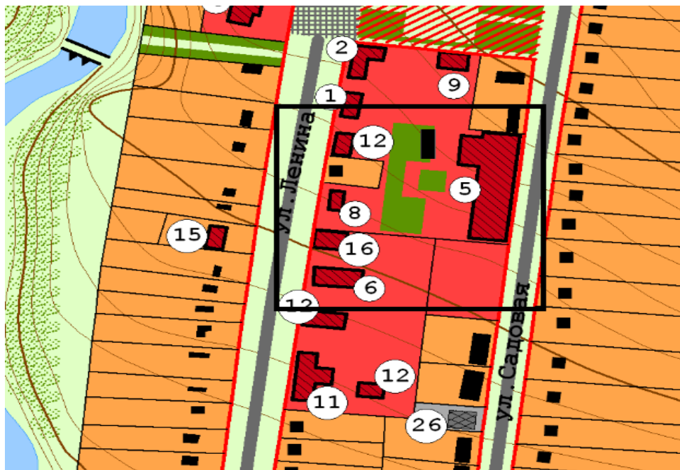
Рисунок 2 - Зона действия котельной №36-05
